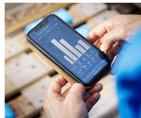
Jedes Modul hat im Test seinen eigenen Laderegler. Sehr praktisch am Smart Solar von Victron: die via App abrufbare Aufzeichnung des Solarertrags.
