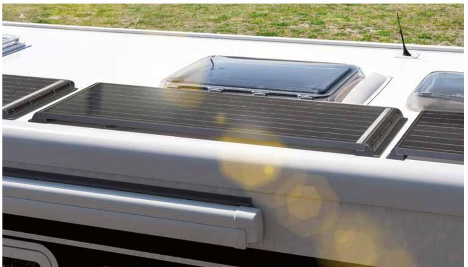
Bewährte Lösung: Durch die Montage der Solarmodule auf Spoiler Profile, die dann auf dem Reisemobildach sicher verklebt werden, wird eine optimale Unterlüftung der Module garantiert. (Foto: Morelo)
