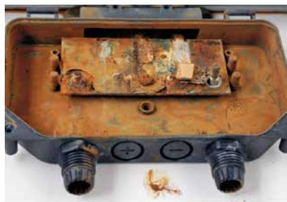
Wenn Feuchtigkeit eindringt ist das Solarmodul irreparabel ...
