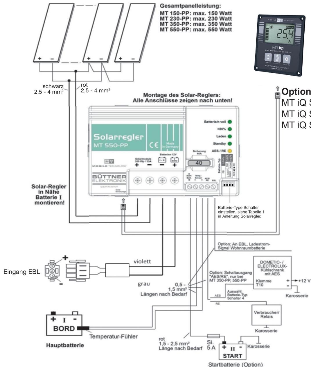
Für Fahrzeuge mit EBL-Elektronikeinheit befindet sich im Lieferumfang ein steckfertiger Kabelsatz. Dieser wird am Solarregler angeschlossen und in den Solar-Eingang an Ihrer EBL eingesteckt. Die Verbindung zur Bordbatterie ist dann sichergestellt. Kontrollieren Sie, ob an Ihrer EBL eine Sicherung vorgesehen und ob diese auch eingesteckt ist !!!
