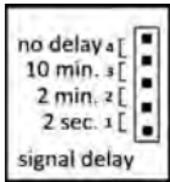
Über Jumper – Steckbrücken ist eine Einstellung von Verzögerungszeiten für die Umschaltung am Signalausgang möglich. Diese können durch Umstecken des Jumpers angepasst werden.
