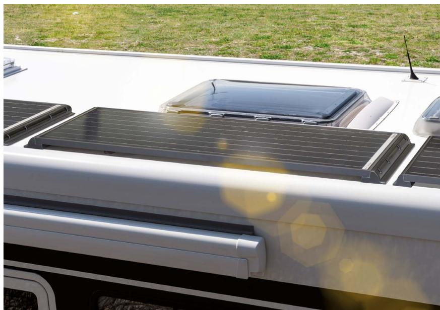
Bewährte Lösung: Durch die Montage der Solarmodule auf Spoiler Profile, die dann auf dem Reisemobildach sicher verklebt werden, wird eine optimale Unterlüftung der Module garantiert.
