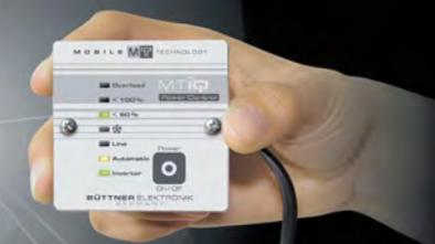
Bedienteil abnehmbar zur Montage im Innenraum
