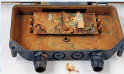
Wenn Feuchtigkeit eindringt ist das Solarmodul irreparabel...
