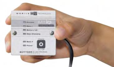
Bedienteil abnehmbar zur Montage im Innenraum
