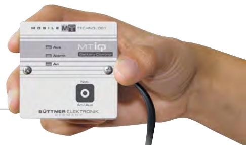
■ Werden einfach in die Plusleitung der Bordbatterie geschaltet und schützt diese vor schädlicher Über- oder Unterspannung. Tritt eine für die Batterie nicht sachgemäße Spannung auf, trennt der **USG** die angeschlossenen Verbraucher ab und schützt Batterie und angeschlossene Verbraucher gleichermaßen. Werden die programmierten Schaltschwellen wieder erreicht, werden die Verbraucher automatisch wieder zugeschaltet.
