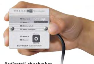
Bedienteil abnehmbar zur Montage im Innenraum
