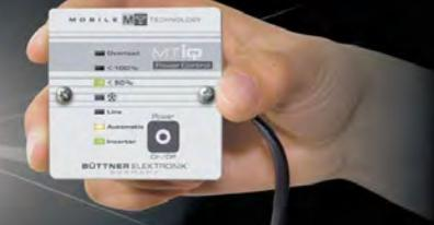
Bedienteil abnehmbar zur Montage im Innenraum
