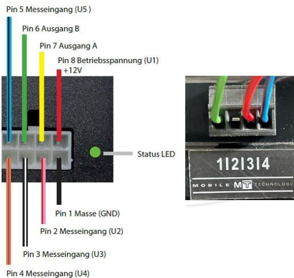
Pin 1 Masse (GND) mit dem Minuspol der LiFePO4-Batterie verbinden.
