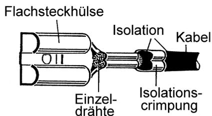
Es ist darauf zu achten, dass das Anschlagen der Flachsteckhülsen sorgfältig ausgeführt wird! Es müssen alle Einzeldrähte der Litze sorgfältig gecrimpt und zusätzlich die Isolation der Litze gecrimpt werden. Eine korrekt angeschlagene Flachsteckhülse siehe nebenstehende Abb.
