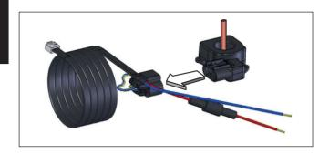
Verbinden Sie nun die beiden Versorgungskabel am Ende des Verbindungskabels mit dem Plus-Pol (rotes Kabel) und dem Minus-Pol (blaues Kabel) der Batterie.
